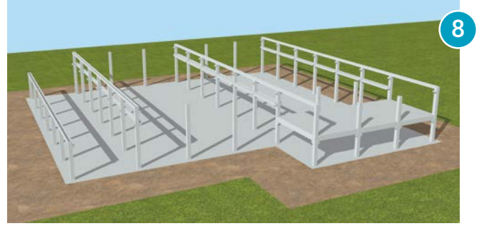
Döşeme Plakaları Kiriş Montajı
